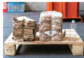
圧縮梱包物外観 ダンボール(左) フレコンバック(右)
