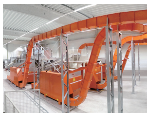
ホッパーやコンベヤ等の付帯設備で 投入の自動化も可能
