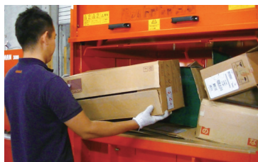
段ボールを畳まず箱のまま投入して圧縮
