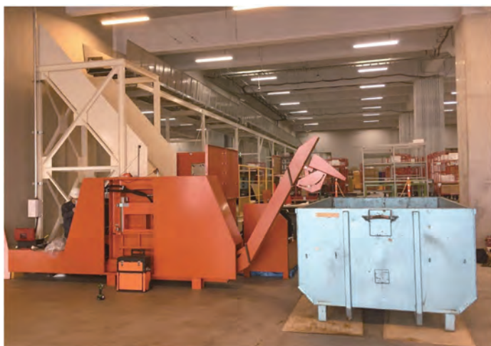
ベルトコンベアで空箱を運び、自動投入
